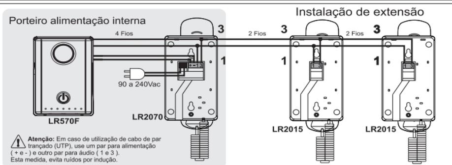
**Atenção:** O monofone Lider modelo LR2015 é totalmente compatível com o modelo LR2010, portanto siga os mesmos procedimentos de instalação.
