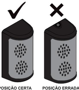
A parte que o parafuso será fixado para manter o semáforo fechado, deverá ficar para baixo, evitando entrada de água.
