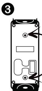
Parafuse a base do semáforo na parede ou local desejado.
