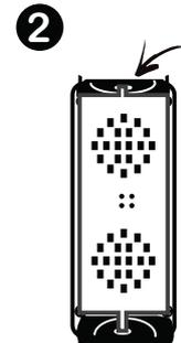
Remova a placa de led, levantando levemente o suporte.
