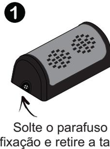
Solte o parafuso de fixação e retire a tampa.
