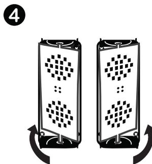
Encaixe a placa novamente e gire a placa de led na direção em que deseja sinalizar e coloque a tampa.
