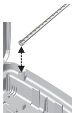
figura 3: instalação da antena
