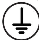
Nota 1: onde possível, recomenda-se que a distância entre qualquer **eletrodo terra da cerca elétrica de segurança** e outros sistemas de aterramento seja de pelo menos 10 m.
