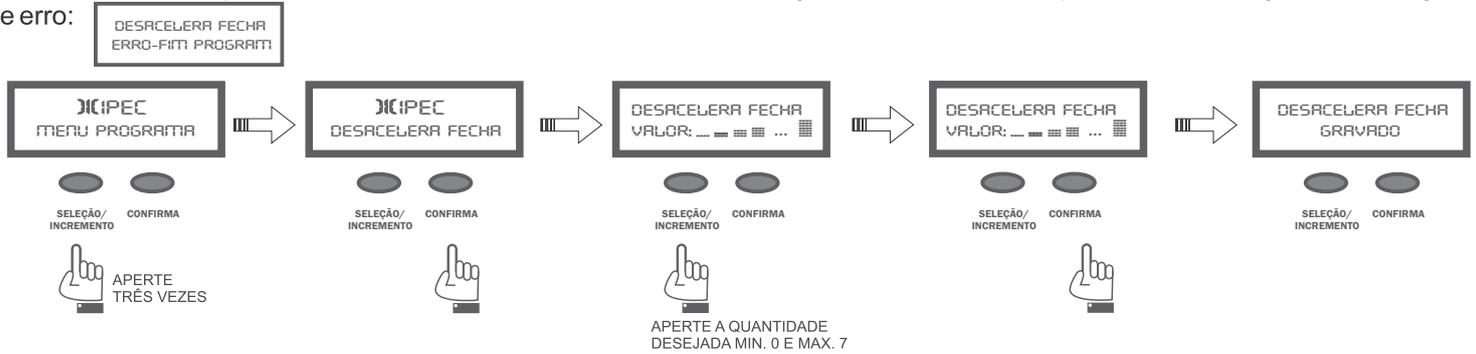
**FUNÇÃO 4 - VELOCIDADE RAMP:** Essa função é responsável pelo ajuste de velocidade da porta durante o processo de desaceleração e da leitura do percurso. São 5 ajustes (lembrando que o valor mínimo é 0 e o valor máximo é 4), onde define a velocidade da porta durante o processo de desaceleração. Ajustar a velocidade de acordo com a necessidade e condições da instalação.
