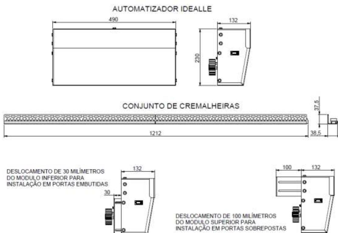
O automatizador IDEALLE pode ser instalado em portas de vidros (TIPO BLINDEX) sem a necessidade de mudança em sua estrutura. O projeto foi desenvolvido no sistema de engrenagens e cremalheiras de fácil adaptação nas portas e com caixarias metálicas modulares, o que facilita a instalação de diversas formas podendo ser instalada em portas com estrutura embutida ou sobreposta dispensando o uso de estruturas adicionais.
