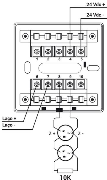
**Para conexão com contato relé (contato seco), conecte os detectores no módulo de endereçamento conforme a figura abaixo**
